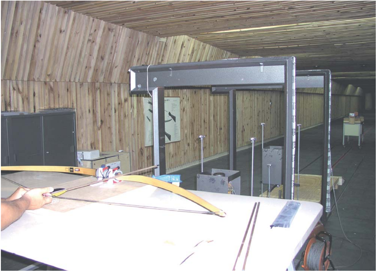
Lám. VIII. Vista de galería de tiro con el arco montado para realizar los tiros experimentales.
